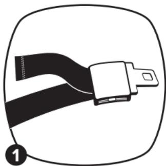
**CONSEIL :** Une façon de savoir si la ceinture sous-abdominale du siège est dotée d'une languette autobloquante est de s'asseoir dans le véhicule et de s'attacher. Tirez doucement sur la ceinture sous-abdominale. Si elle reste serrée, c'est qu'elle est autobloquante.
